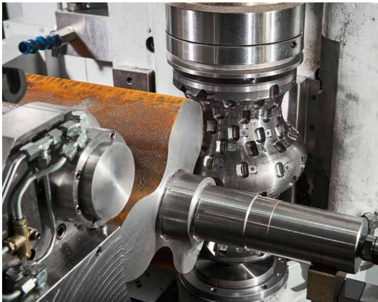
Roots-type blower production on PTG Holroyd 4EX-R-BL machine. (Courtesy: PTG Holroyd)
